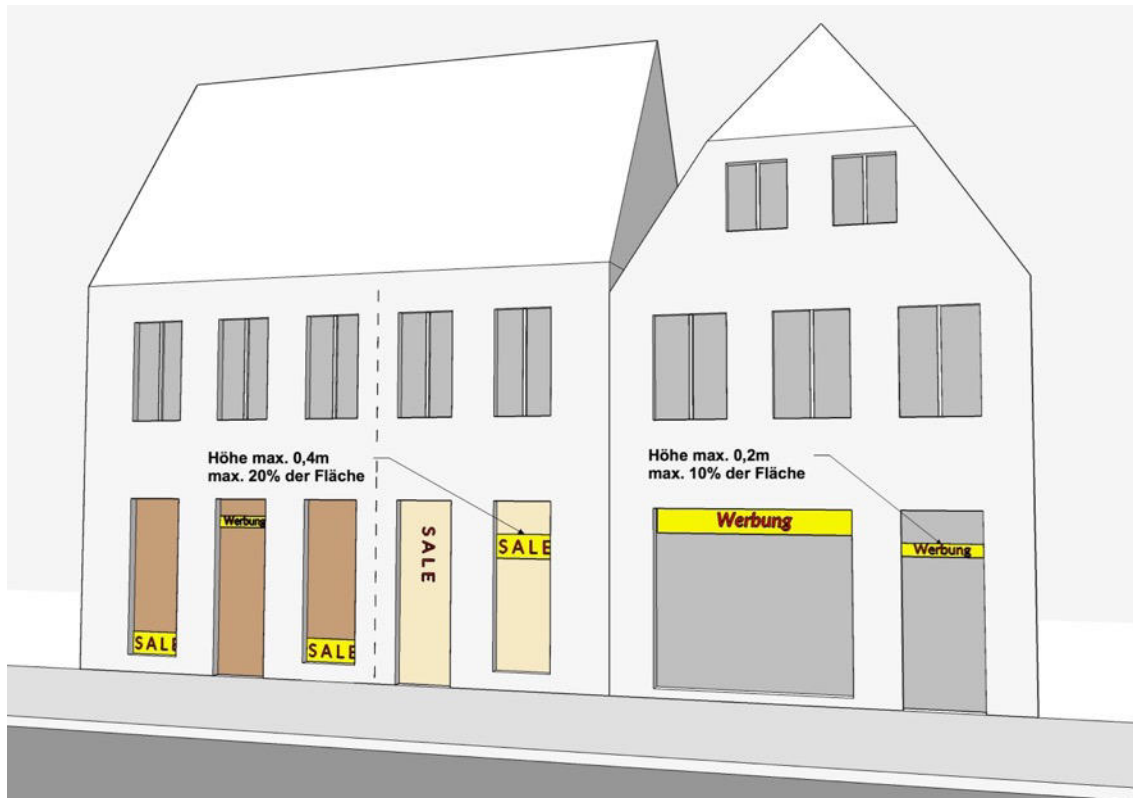
Abbildung 31: Werbeanlagen in den Schaufensteröffnungen gem. Nr. 17.2.2
